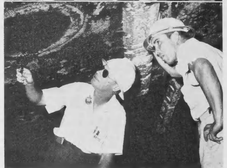
FUTURE MATES watch progress of the drydocking, top photo. J. E. Kirwin, bottom photo, left, and H. A. Kelly check protection given by aluminum anodes to the tug's hull. STUURMANNAN DI futuro ta waak e progreso di e proceso di drydock, J. E. Kirwin y H. A. Kelly ta check e proteccion duná door di un capa di aluminum.
